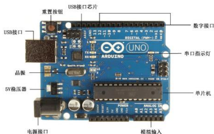
图 10-1 Arduino UNO 功能标注
