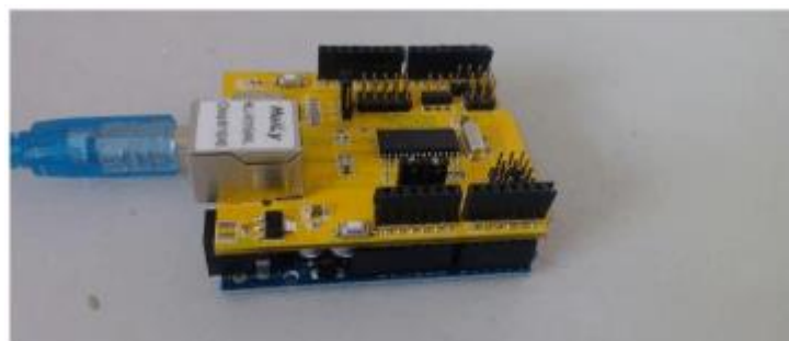
图 10-3 Arduino UNO 与网络拓展板连接
